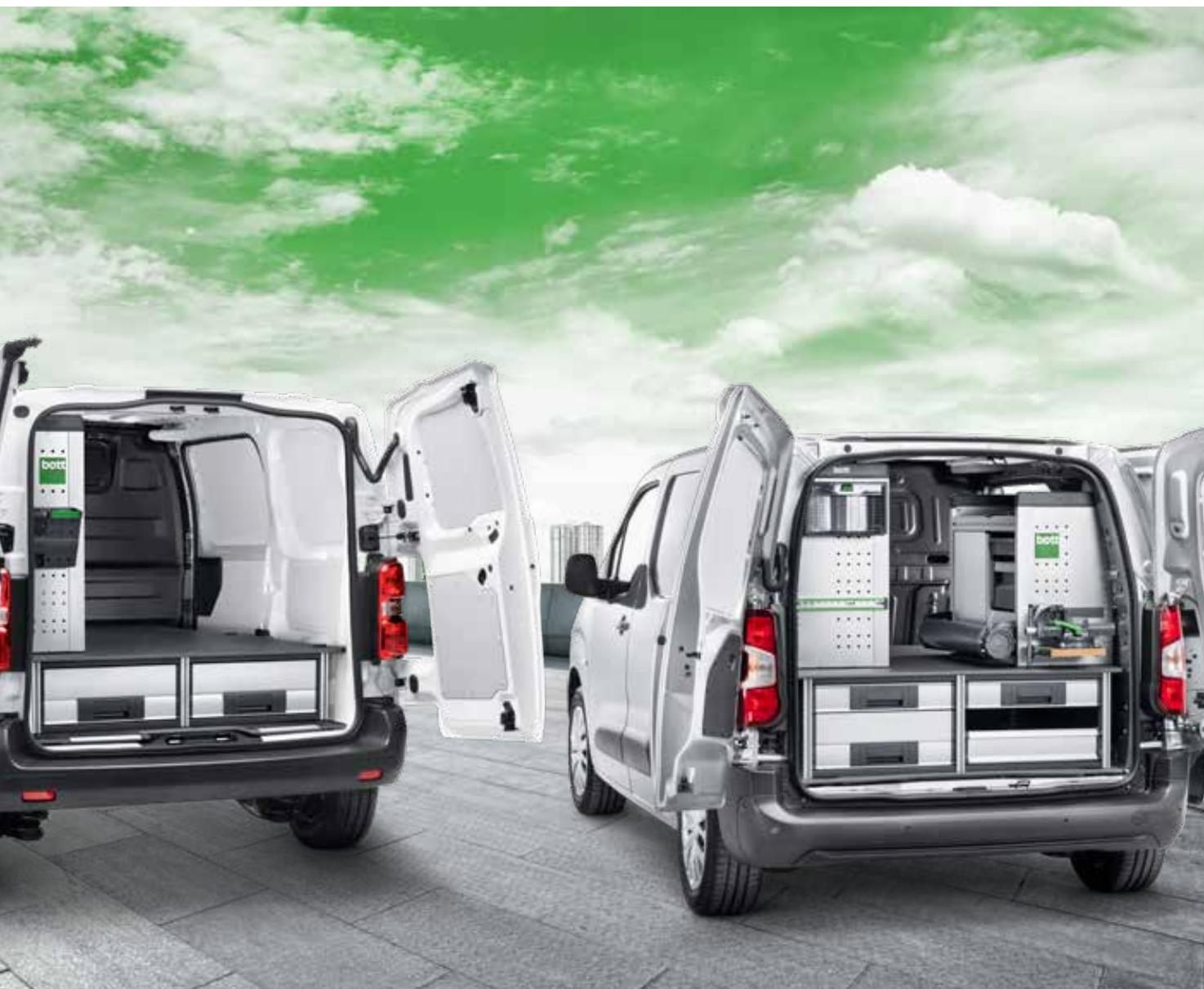
I moduli dell'allestimento bott vario3 per il vostro veicolo commerciale offrono numerosi elementi per organizzare il volume di carico. Questi elementi si possono combinare perfettamente per ogni esigenza personalizzata del vostro lavoro. Per l'allestimento veicoli commerciali bott vario3, i progettisti hanno prestato particolare attenzione alla sicurezza e all'utilizzo ideale dello spazio disponibile.
